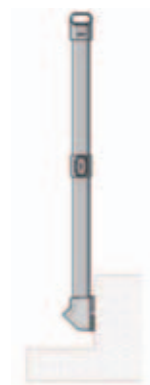
Droit en applique sur mur ou acrotère Straight against wall or parapet
